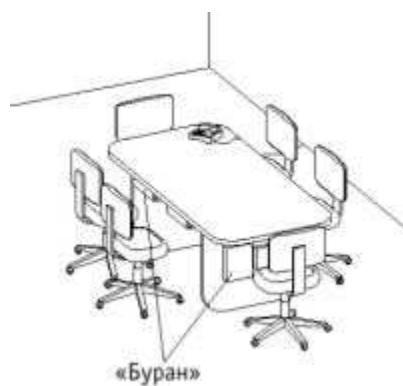
Рис. 5: Схема размещения устройства подавления диктофонов "Буран 3" в области стола для переговоров
